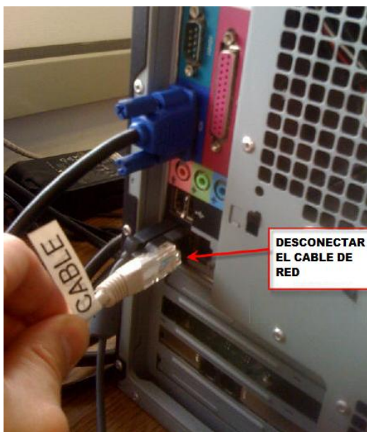
Figura 10. Desconexión de unidades de red
